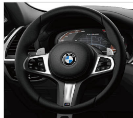
M款多功能真皮方向盤(含換檔撥片) X4 xDrive30i M Sport / X4 M40i
