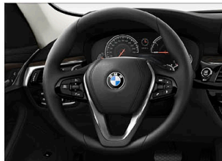
跑車多功能真皮方向盤 (含換檔撥片) 520d / 520d Luxury / 530i Luxury
